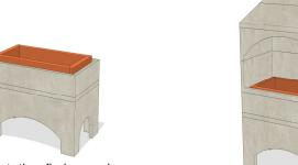
10) Set the chimney cap using type S mortar.
